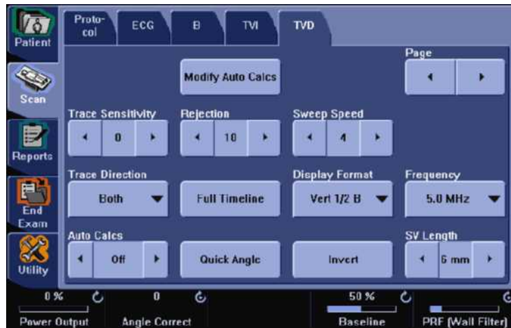
Figura 5-57. Panel táctil del modo VTD 1
