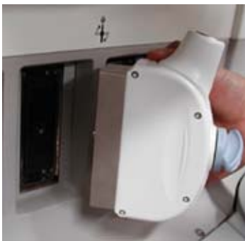
Figura 3-32. Alinee el conector con el puerto de la sonda (izquierda). Inserte el conector de la sonda en el adaptador (derecha).
