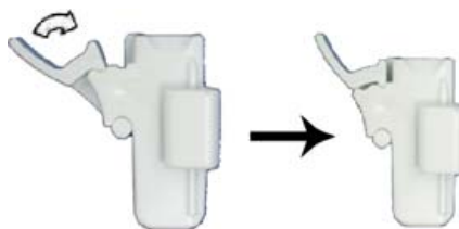
Figura 17-21. Bloqueo del clip de la aguja
