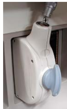
Figura 3-32. Alinee el conector con el puerto de la sonda (izquierda). Inserte el conector de la sonda en el adaptador (derecha).
