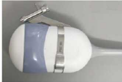
Figura 17-37. Montaje de la guía de la aguja de biopsia en la sonda 4D3C-L
