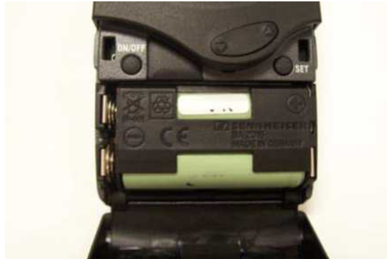
Figura 6-16. Inserción de la BA2015 Accupack en el TPI
