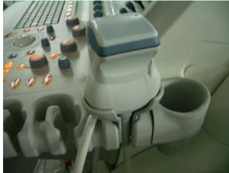
Figura 3-31. Soporte de la sonda 4D con la sonda
